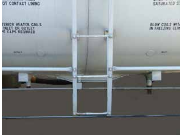
Esta foto ilustra las entradas y salidas del serpentín para calentamiento en la parte inferior de un carro tanque.
