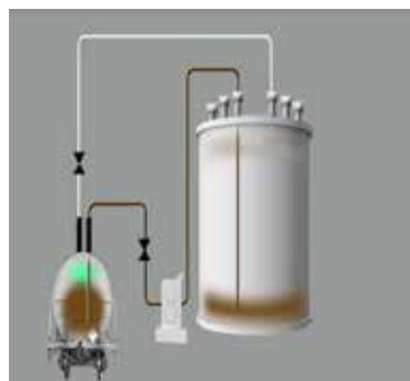
Figura 8: Transferencia por bomba desde un carro tanque con intercambio de vapor
