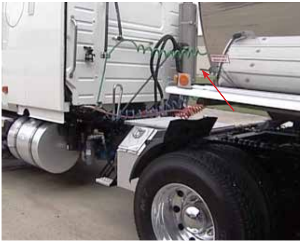
La flecha en la foto arriba señala el dispositivo remoto para cierre de emergencia para un remolque cisterna.
