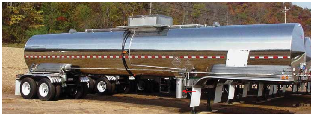
La flecha arriba en la foto indica el secador con desecante ubicado en un remolque cisterna.
