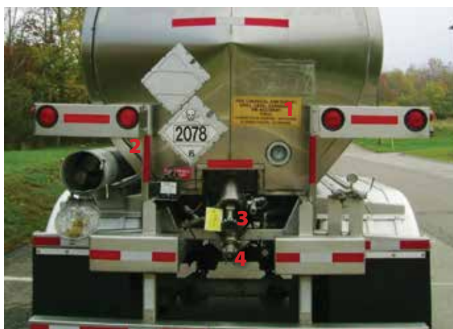
La foto arriba ilustra la zona de descarga posterior de un remolque cisterna: 1) Indicador de temperatura; 2) Gato hidráulico para operar la válvula interna; 3) Válvula externa; 4) Conexión de descarga de 2 pulgadas.
