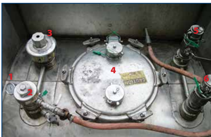
La foto arriba señala los accesorios superiores de un remolque cisterna: 1) Indicador de presión; 2) Dispositivo de alivio de vacío; 3) Dispositivo de alivio de presión; 4) Entrada hombre; 5) Válvulas/ accesorios de intercambio de vapor; 6) Línea de aire del secador con desecante.
