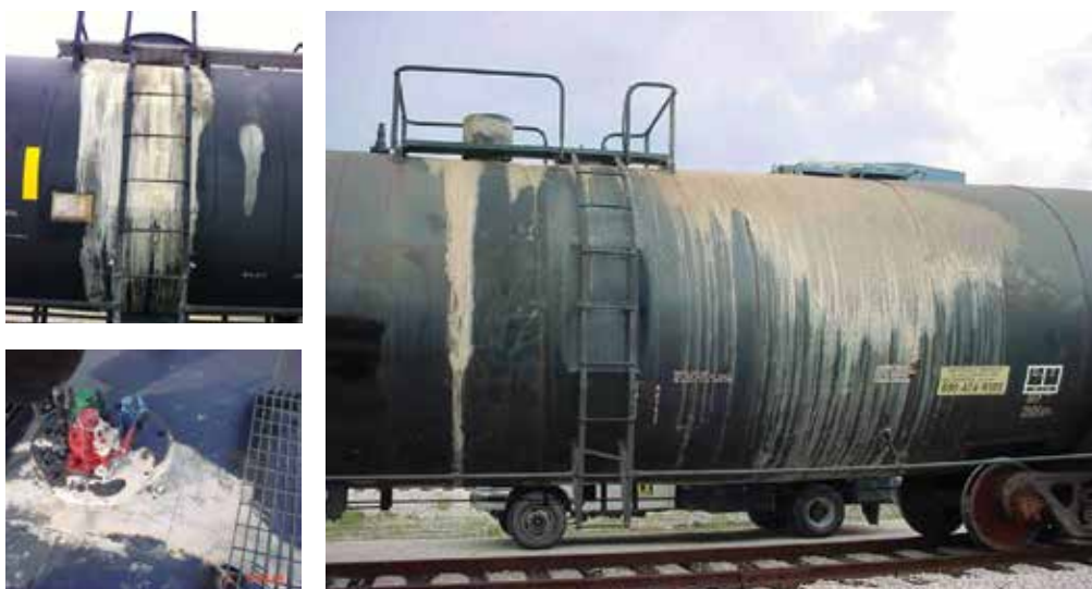
Las fotos arriba ilustran un vagón con residuos externos que deberían ser removidos antes del transporte.
