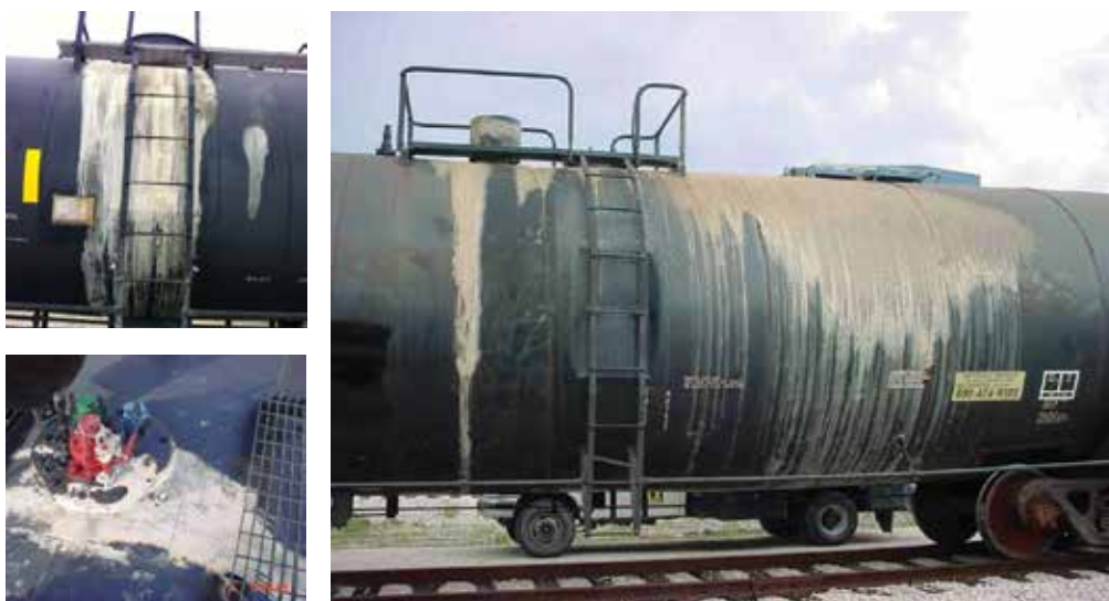
Les photos ci-dessus représentent des résidus à l'extérieur d'un wagon-citerne, qui devront être éliminés avant le retour de celui-ci.
