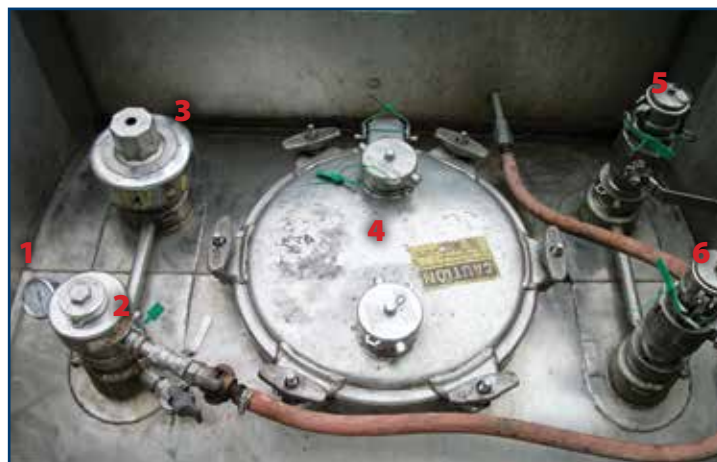
La photo ci-dessus indique les raccords sur le dessus d'une remorque citerne : 1 ) Manomètre ; 2 ) reniflard ; 3 ) soupape de pression ; 4 ) trappe d'accès ; 5 ) vannes et raccords d'intercommunication des espaces libres ; 6 ) arrivée d'air du dessiccateur.
