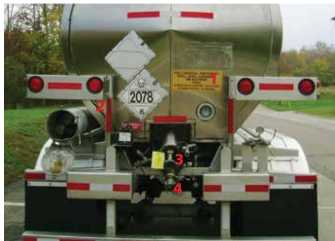
La photo ci-dessus représente la partie déchargement à l'arrière de la citerne : 1 ) thermomètre ; 2 ) vérin hydraulique de commande de la vanne interne ; 3 ) vanne extérieure ; 4 ) raccord de déchargement ( 2 pouces ).
