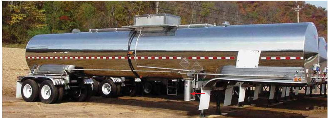
La flèche de la photo ci-dessus indique l'emplacement du dessiccateur sous la citerne.
