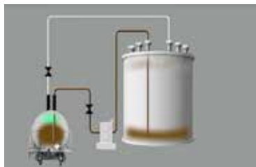
Figure 8 : Soutirage par pompage d'un wagon-citerne avec intercommunication des espaces libres
