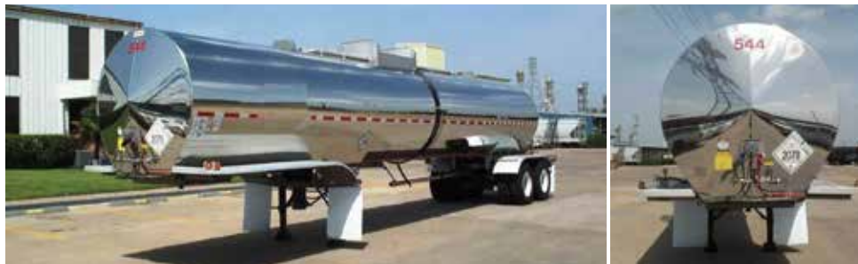
Les photos ci-dessus représentent une remorque citerne standard conforme à la spécification DOT 407.
