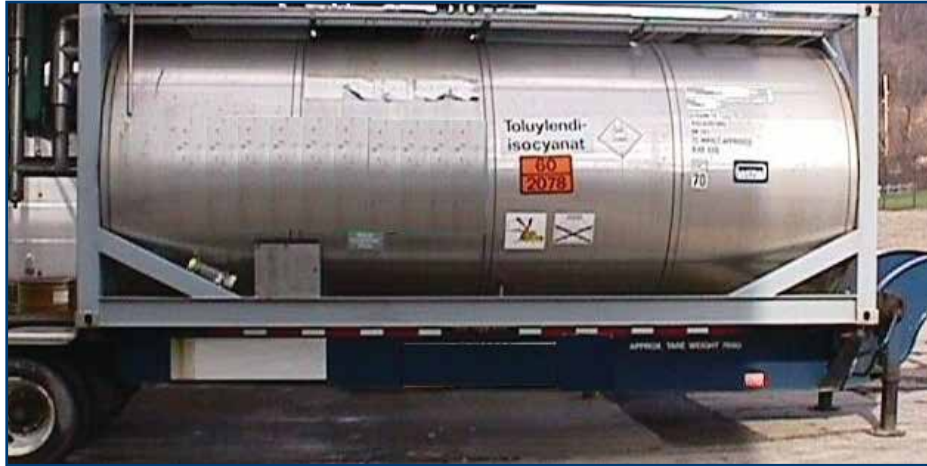
L'image ci-dessus représente une citerne intermodale type à remplissage par le haut.
