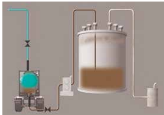
Figure 2 : Soutirage par pompage avec pression d'assistance
