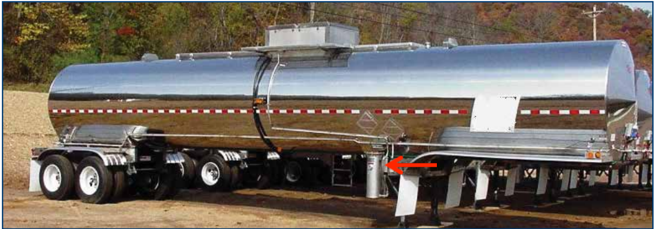
La flecha arriba en la foto indica el secador con desecante ubicado en un remolque cisterna.
