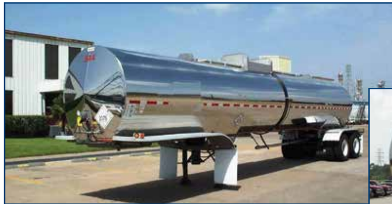
Las fotos arriba ilustran un típico remolque cisterna con especificación DOT 407.
