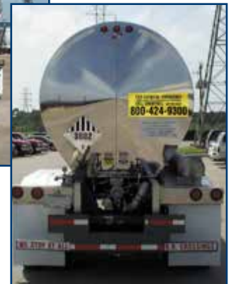
Las fotos arriba ilustran un típico remolque cisterna con especificación DOT 407.
