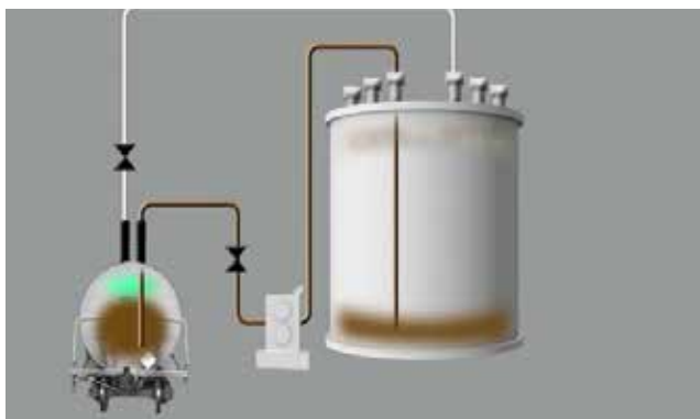
Figura 8: Transferencia por bomba de carros tanque de ferrocarril con intercambio de vapor
